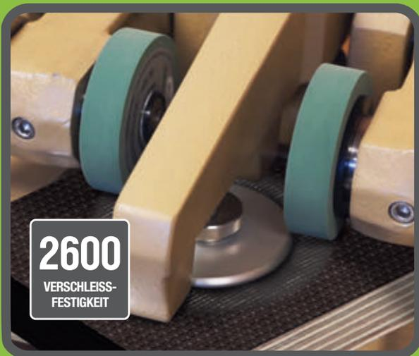
Hohe Widerstandsfähigkeit gegenüber Oberflächenverschleiß – mindestens 2600 Umdrehungen (Taber-Test nach EN 438-2:2016). Dies ist fünf mal höher als bei herkömmlichem Sperrholz\*.
