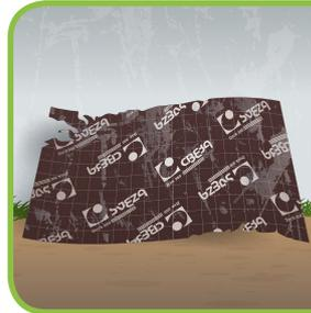
Depois de desmontar a cofragem, inspecione o contraplacado. Remova os restos do betão. Não use placas fortemente deformadas em trabalhos seguintes. Se o estrago for insignificante, use as placas para elementos não padronizados.
