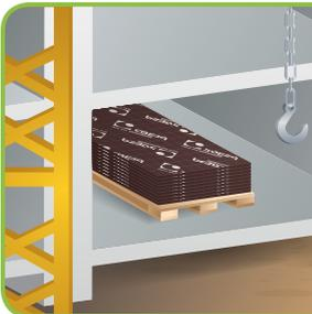
O contraplacado destinado à montagem da cofragem dos pisos seguintes, deve ser arrumado com cuidado numa pilha para ser posteriormente deslocado por um guindaste.
