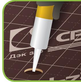
Todos os orifícios originados durante o trabalho de instalação devem tapar-se com silicone para evitar a entrada de humidade.
