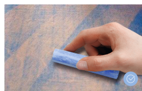
LA QUALITÉ DE LA SURFACE EST VÉRIFIÉE À L'AIDE D'UNE CRAIE
