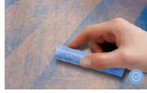
تم التأكد من عدم وجود عيوب في السطح باستخدام الطباشير
