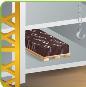
Die zur Verwendung auf höher gelegenen Stockwerken gedachten Schalungsplatten sollten durch einen Kran befördert werden um Beschädigungen zu vermeiden.
