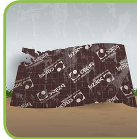
Nachdem die Schalung entfernt wurde, prüfen Sie das Sperrholz. Entfernen Sie überschüssigen Beton. Verwenden Sie stark verformte Platten nicht für weitere Arbeiten. Wenn der Schaden gering ist, verwenden Sie die Platten für Sonderelemente.
