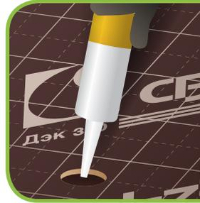
Alle auf der Baustelle vorgenommenen Bohrungen, zB. Bei der Installation, sollten später mit einem silikonbasiertem Kleber wieder abgedichtet werden um die Platte vor Feuchtigkeit und Aufquellen zu schützen.
