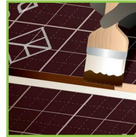
Después del corte del tablero contrachapado proteja los bordes sellándolos para evitar la atracción de humedad.
