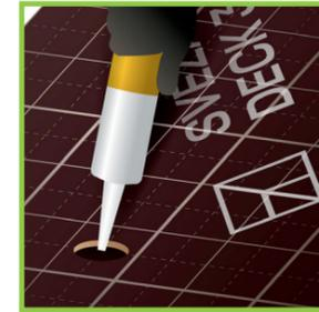
Todos los orificios originados durante el trabajo de montaje deben taparse con cola de silicona para evitar la filtración de humedad [hinchazón].
