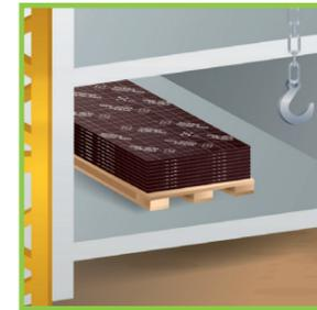
El tablero contrachapado destinado al montaje del encofrado de las plantas siguientes, debe colocarse en la pila con cuidado para su posterior traslado con la ayuda de una grúa.
