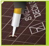
Combler les trous realises au court des travaux par une colle a base de silicone afin de sceller les entrees d'humidite
